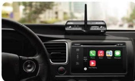
Com Probe Sodera 是Frontline 公司为专业开发者和工程师重新设计的一款蓝牙协议分析仪，让分析工作更加快速简单，使客户产品可以更快一步进入市场。只需按下“捕捉”键，即可抓取附近所有蓝牙连接和数据，包括发现/连接交互、SSP配对等等。
